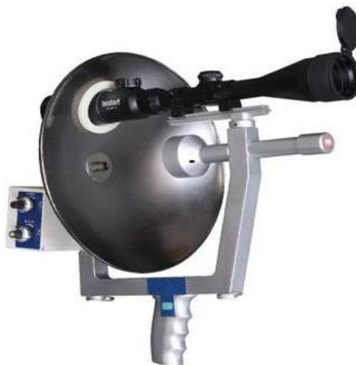
Рисунок 4.1. - Дефектоскоп для дистанционной проверки изоляторов ДД-610
