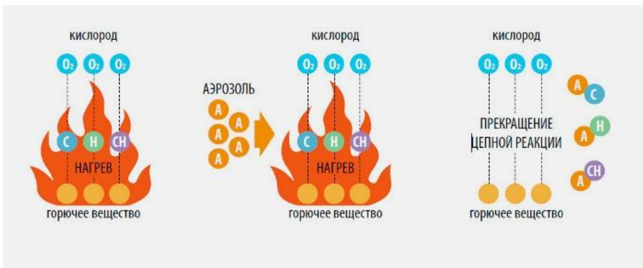
Рисунок 3.2 - Принцип тушения пожара при помощи аэрозоля
