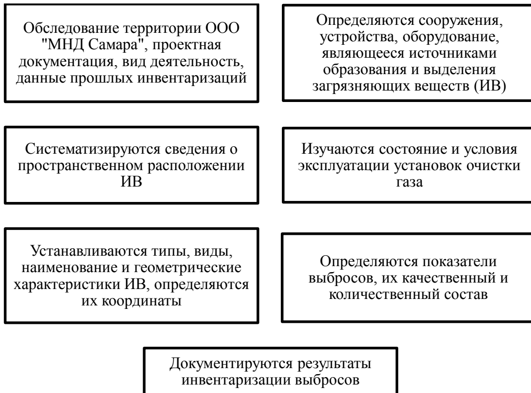
Рисунок 6.2 - Документированная процедура проведения инвентаризации стационарных источников и выбросов вредных (загрязняющих) веществ в атмосферный воздух в ООО «МНД Самара»
