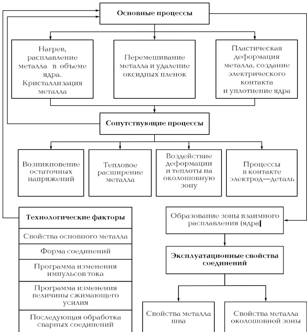
Рисунок 16 – Схема процессов образования соединений при контактной точечной сварке [2].
