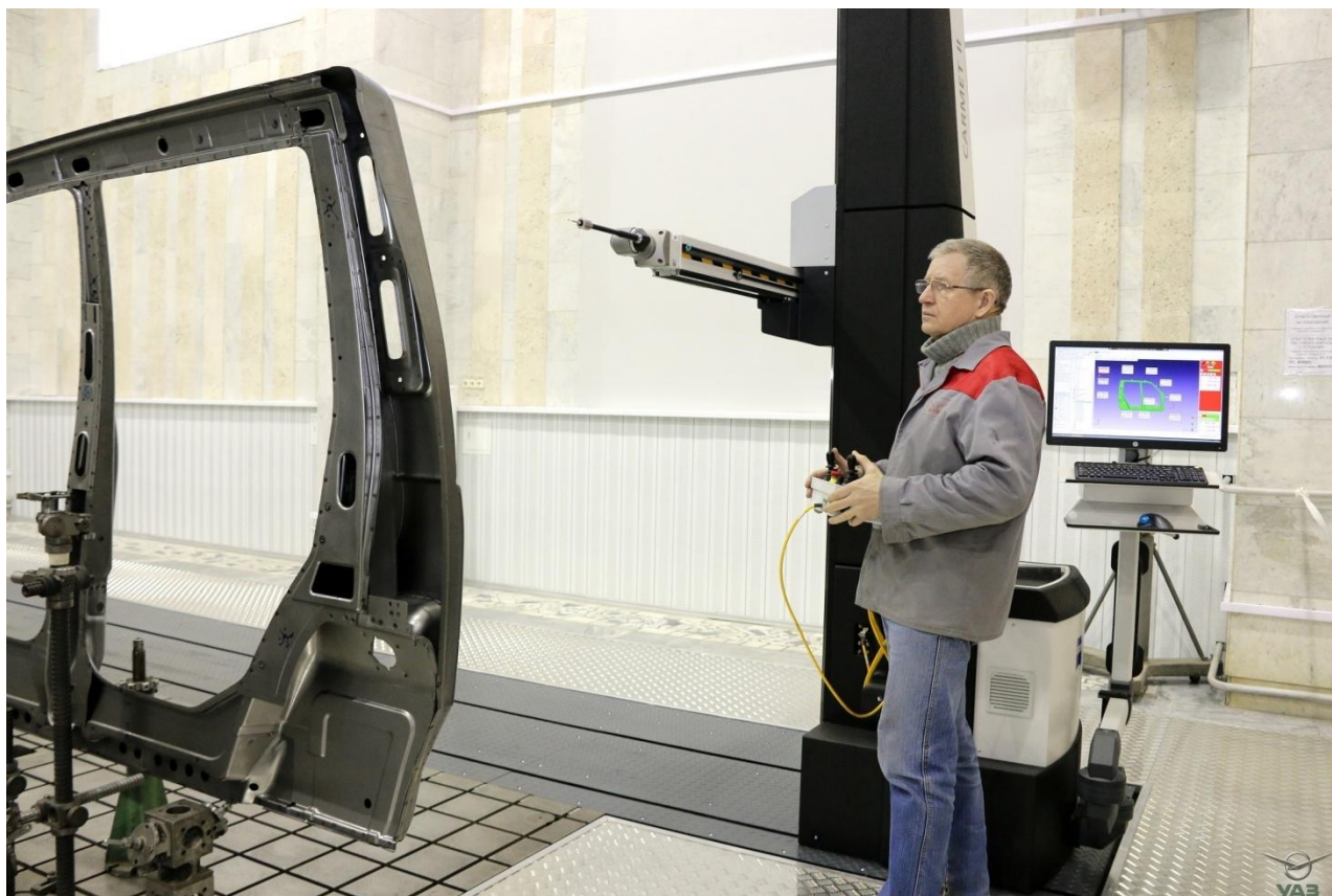
Рисунок 24 - Координатная измерительная машина PROPremium 16/21 для направляющих балок.
