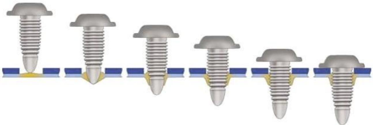
Порядок закручивания болтов Flow Drill
