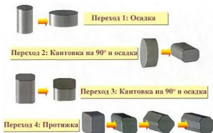
Рисунок 2.1 – Принципиальная схема всесторонней изотермической ковки
