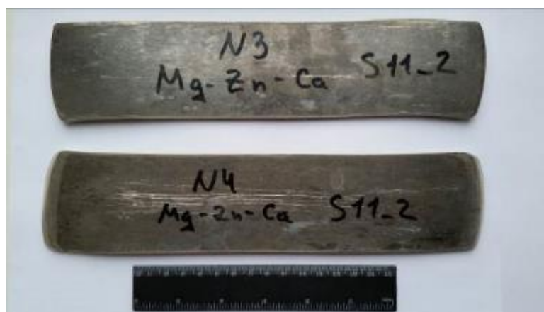
Рисунок 2.5 – Внешний вид листов сплава системы Mg-Zn-Ca (S11) после ВИК с понижением температуры, осадки и изотермической прокатки (S11- VIK1P)
