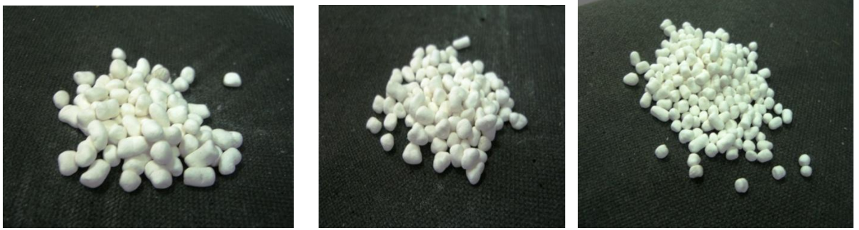
Рисунок 2.6 - Гранулированная соль сепарированная по фракциям
