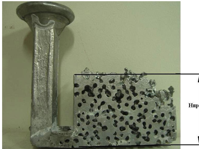
Рисунок 2.8 - Определение глубины пропитки- Нпр
