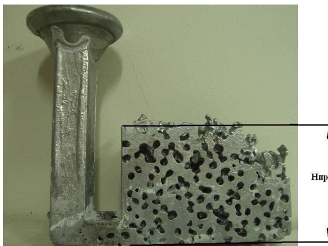
Рисунок 3.13 - Определение глубины пропитки при заливке снизу - H_{\text{пр}}
