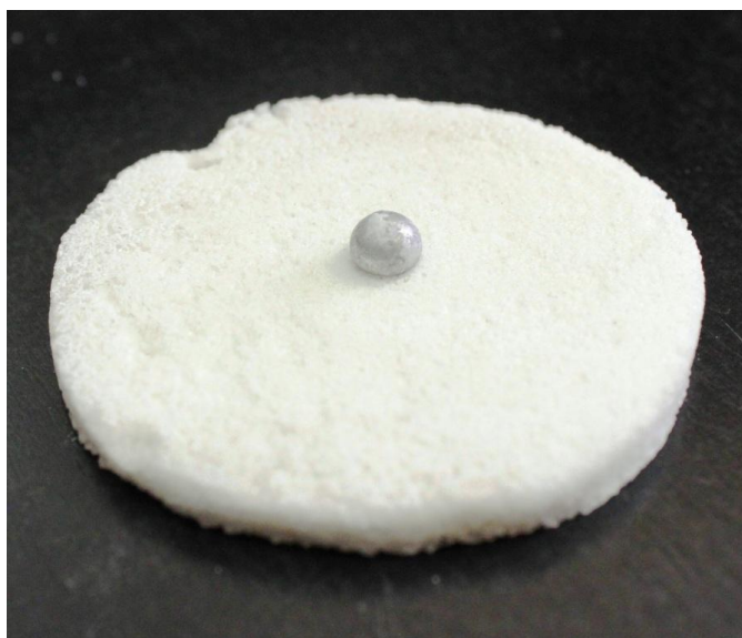
Рисунок 3.9- Смачиванию соли расплавом алюминия при температуре 750^{\circ}\text{C}
