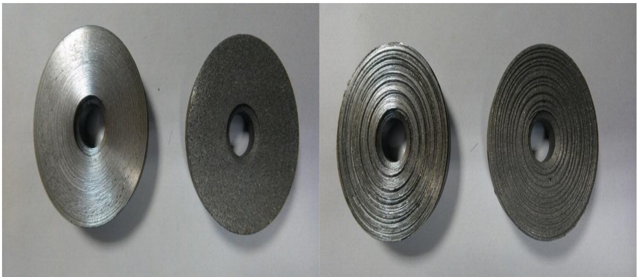
а) механическая обработка; б) абразивно-струйная обработка никельшлаком; в) “рваная резьба”, нарезанная по спирали Архимеда; г) с “рваная резьба” и последующая абразивно-струйная обработка никельшлаком Рисунок 31 - Образцы из стали 20 с различным характером подготовки поверхности
