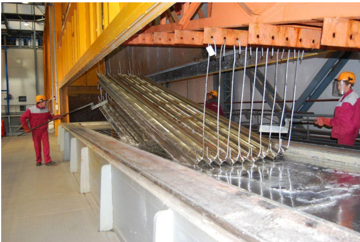
Рисунок 4 Жидкофазное алитирование балок стальных конструкций
