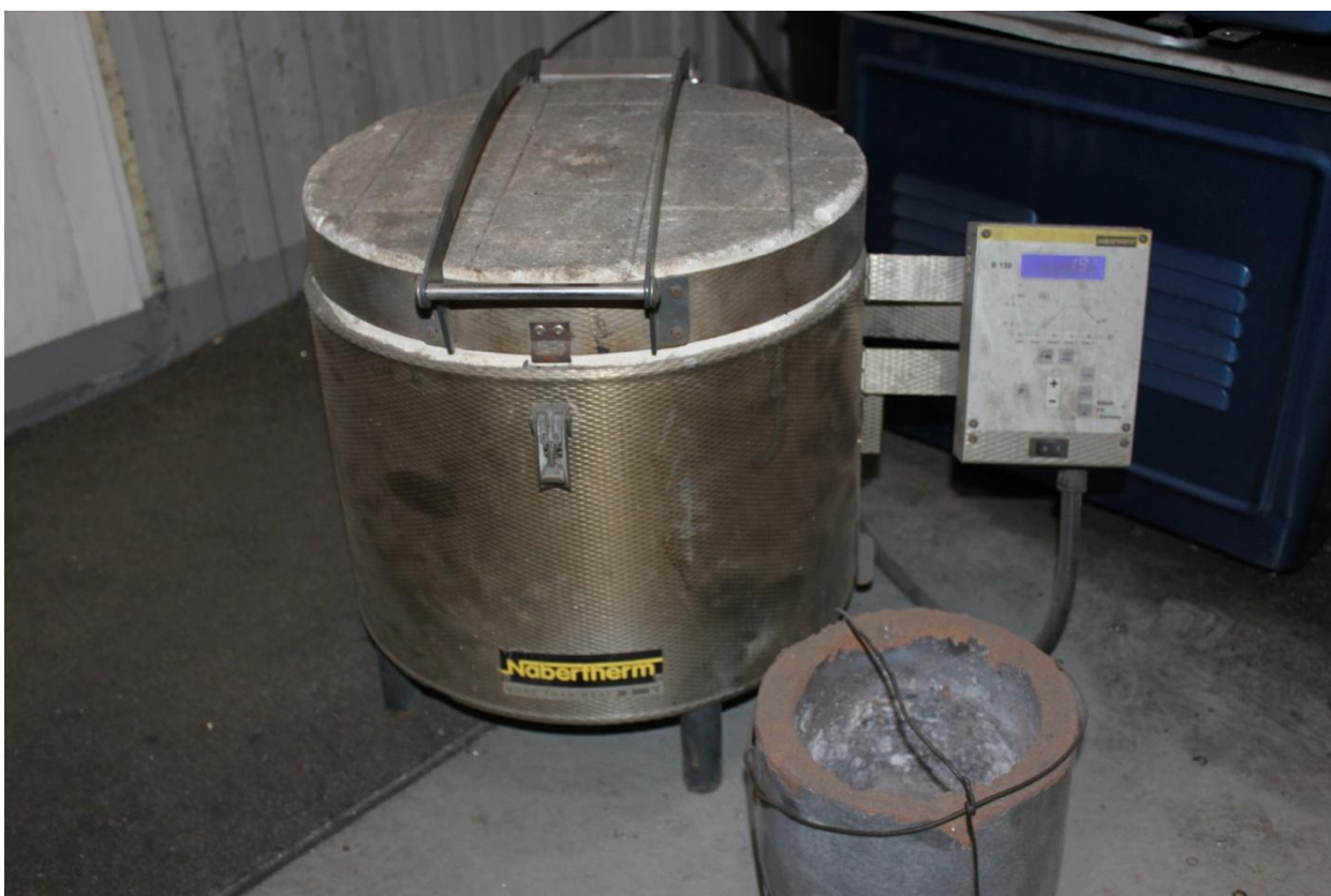
Рисунок 34 - Печь Nabertherm Top 45 ECO, тигель для плавки алюминия
