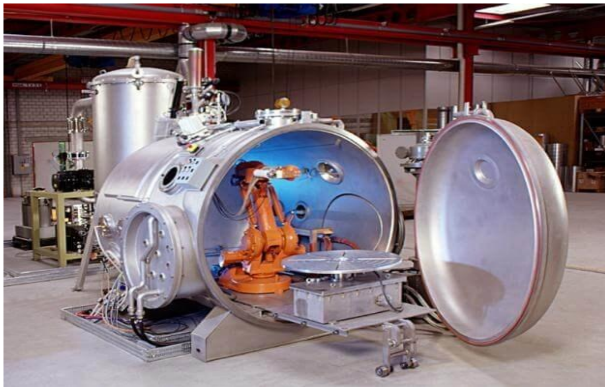
Рисунок 8 - Установка плазменного напыления в вакуумной камере
