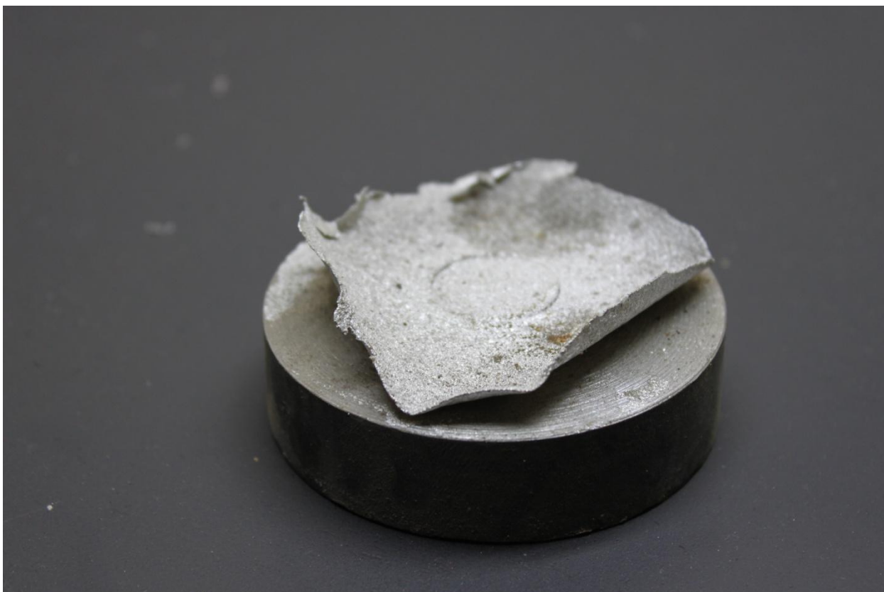
Рисунок 37 - Внешний вид образца №1 после нанесения покрытия
