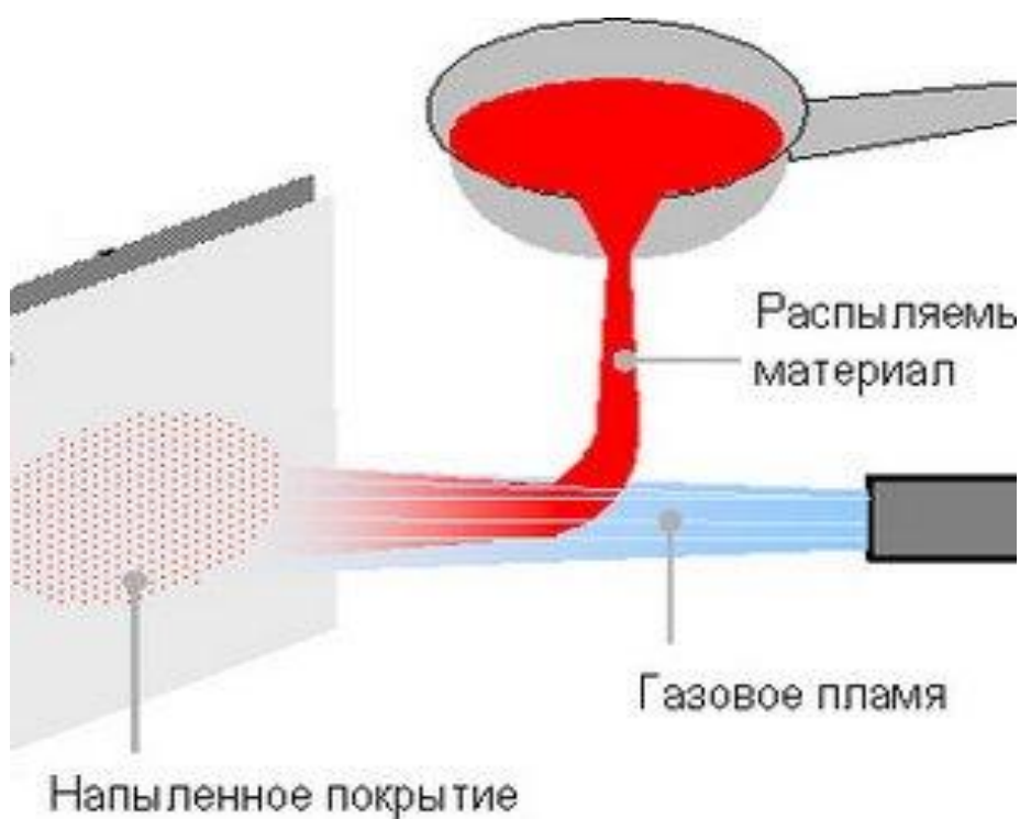
Рисунок 5 - Первый способ металлизации предложенный М. Шооп
