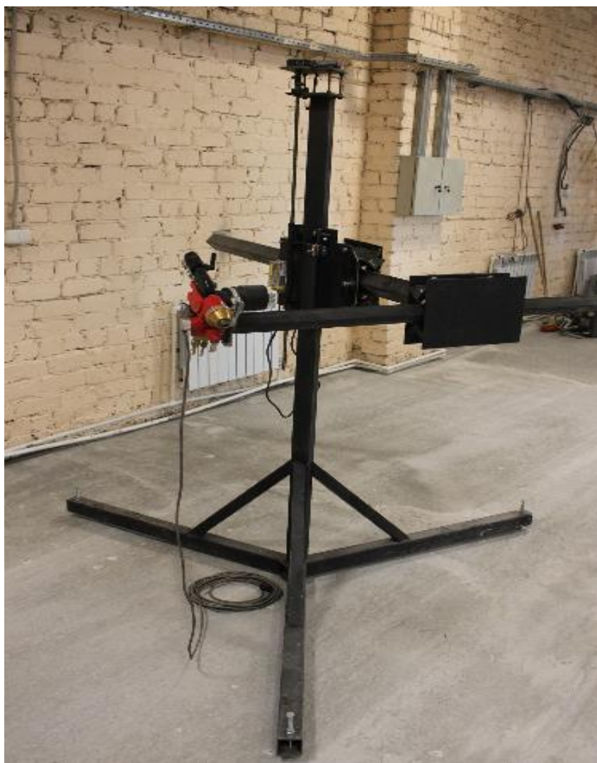
Рисунок 29-Общий вид установки для газопламенного напыления с металлизатором Плакарт FS-15
