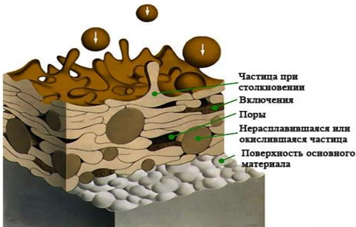
Рисунок 10 - Структура покрытия полученного газопламенным напылением
