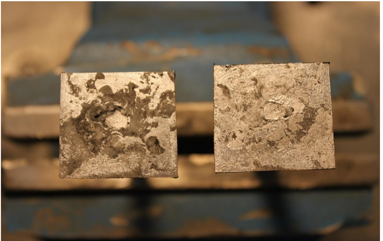
Рисунок 49 - алюминиевое покрытие на стали после испытания образца при температуре 700 °С
