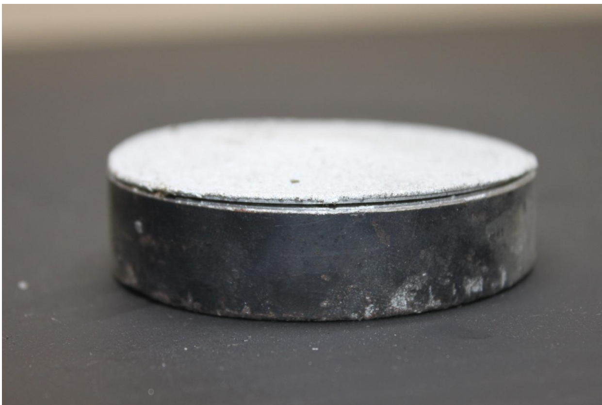
Рисунок 38 - Внешний вид образца №2 после нанесения покрытия
