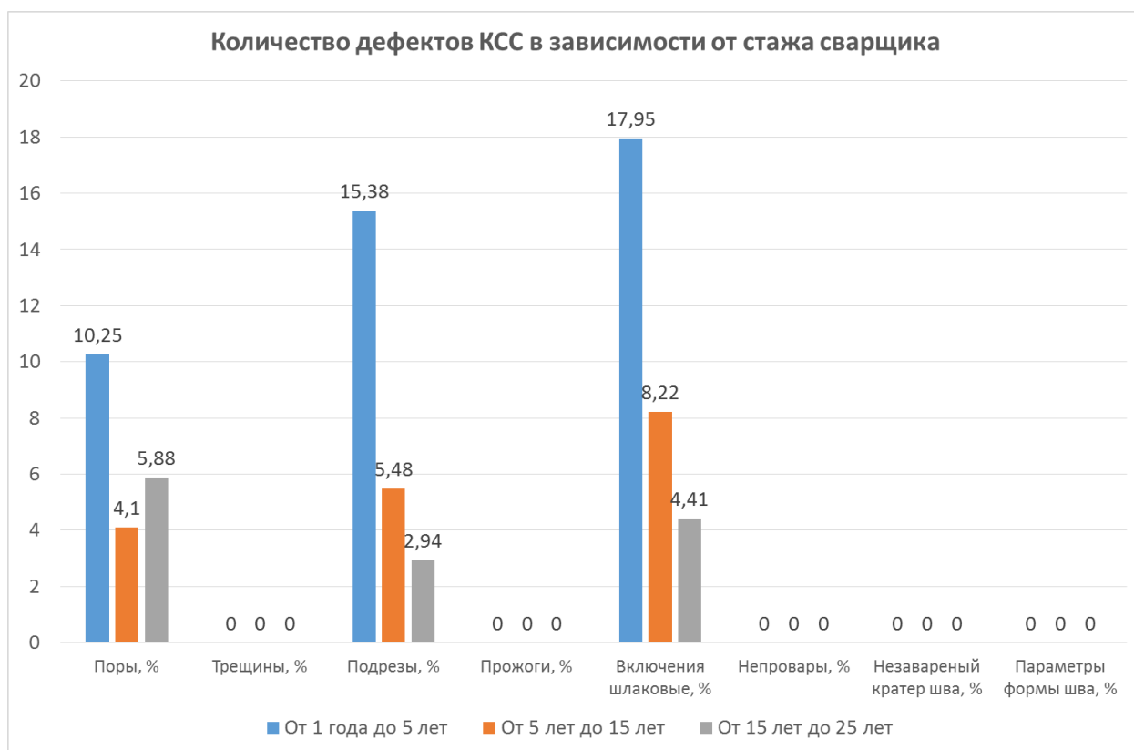
Рисунок 20 - Количество дефектов КСС в зависимости от стажа сварщика.
