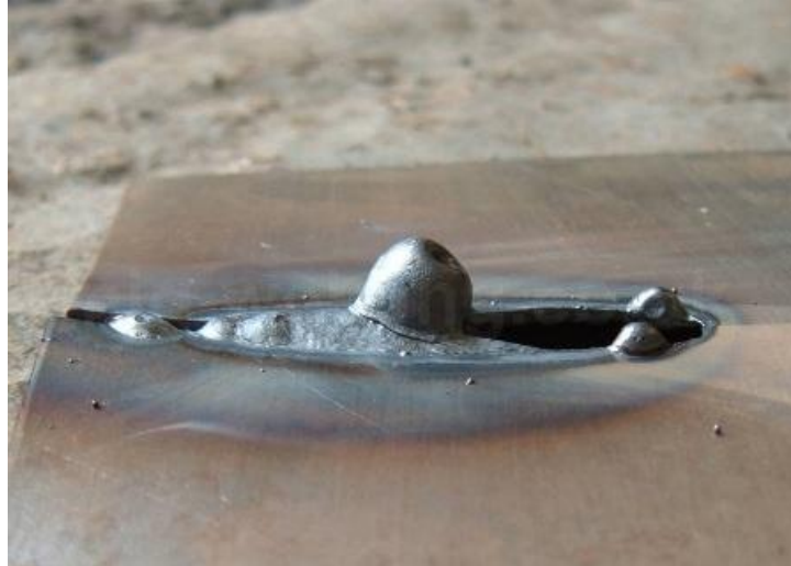
Рисунок 15 – Прожог сварного соединения
