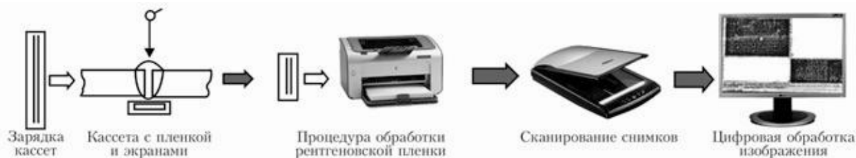
Рисунок 22 - Традиционная схема радиографического контроля с использованием пленки и оцифровки рентгенограмм.
