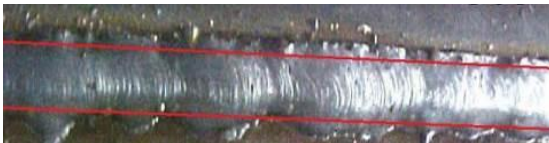
Рисунок 17 – Неравномерная ширина шва
