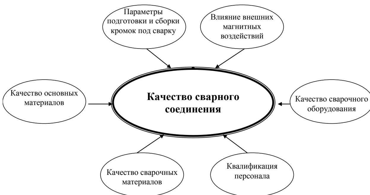
Рисунок 1 - Факторы, влияющие на качество формирования сварного соединения
