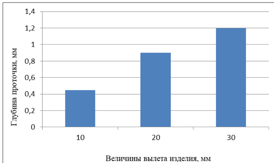
Рисунок 2.4 - Рекомендуемая глубина проточки в зависимости от вылета изделия из цанги, мм
