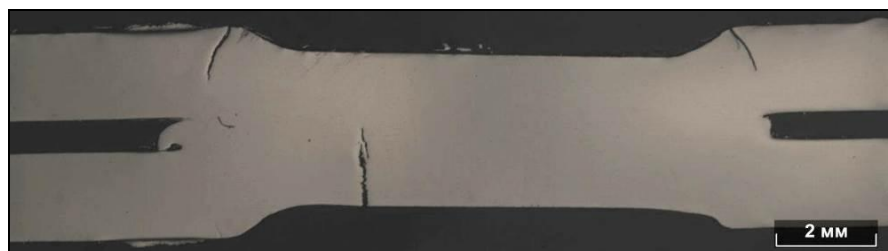
Рисунок 1.5 – Трещины с поверхности сварной точки
