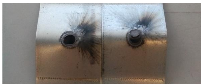
Рисунок 2.18 – Сварной образец после испытаний на отрыв с полным отрывом литого ядра и выплеском
