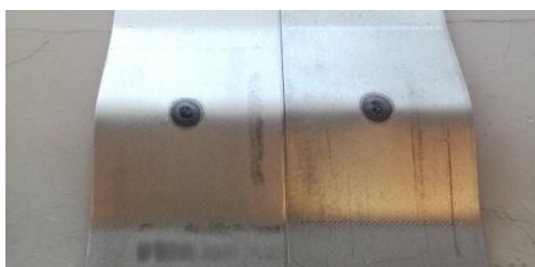
Рисунок 2.17 – Сварной образец после испытаний на отрыв с частичным разрушением литого ядра
