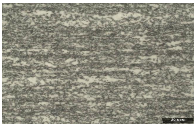
Рисунок 1.4 – Микроструктура в продольном направлении при 1000 кратном увеличении
