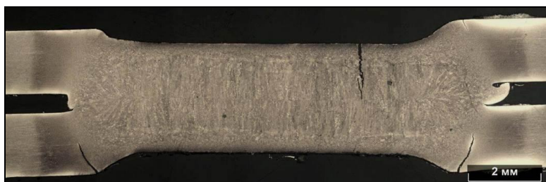
Рисунок 2.23 – Трещины с поверхности сварной точки. Трещины в зоне термического влияния
