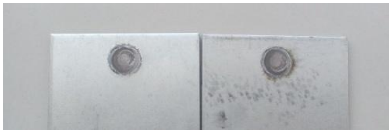
Рисунок 2.16 - Сварной образец после испытаний на срез
