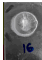
Рисунок 3.13 - Внешний вид сварных точек при сварке АМГ-3 образцов толщиной (2+2) мм
