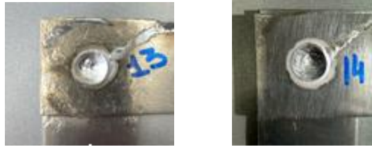
Рисунок 3.8 – Внешний вид сварных точек при сварке АМг-3 образцов толщиной (2+2) мм
