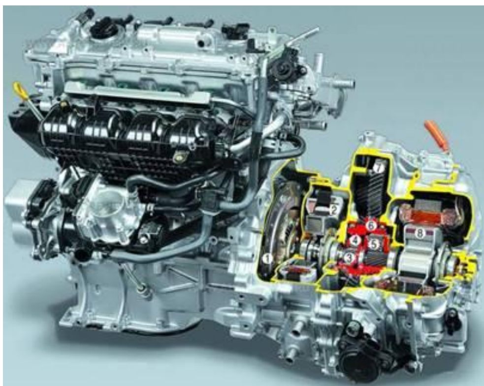
Рисунок 2.11– Планетарная трансмиссия автомобиля Toyota Prius:
