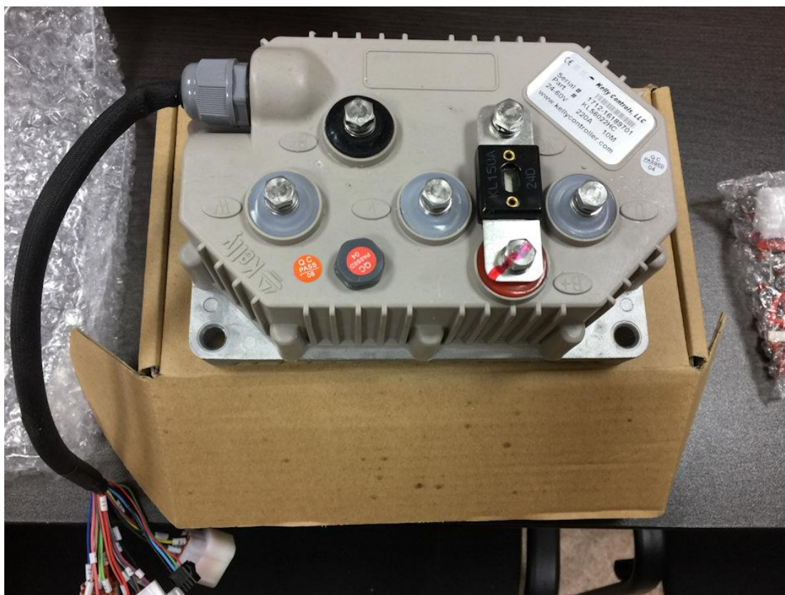
Рисунок 5.1 – Контроллер Kelly Controls/ Part: KLS7245HC
