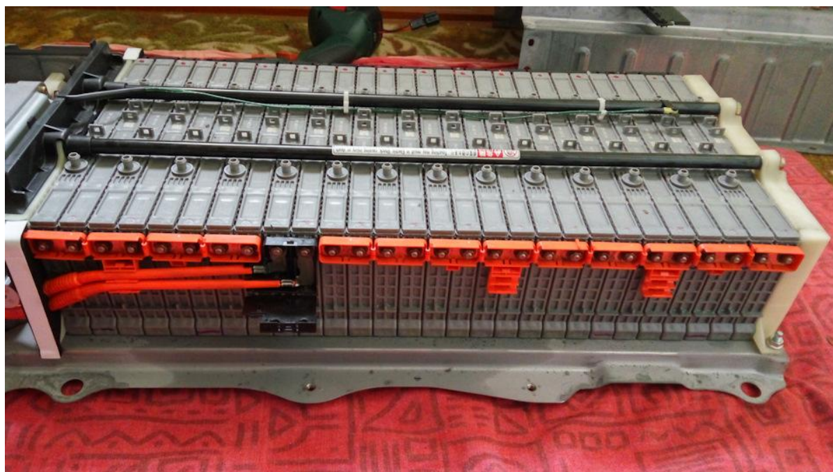
Рисунок 3.2 – Внешний вид никель-металлогидридной батареи Toyota Prius
