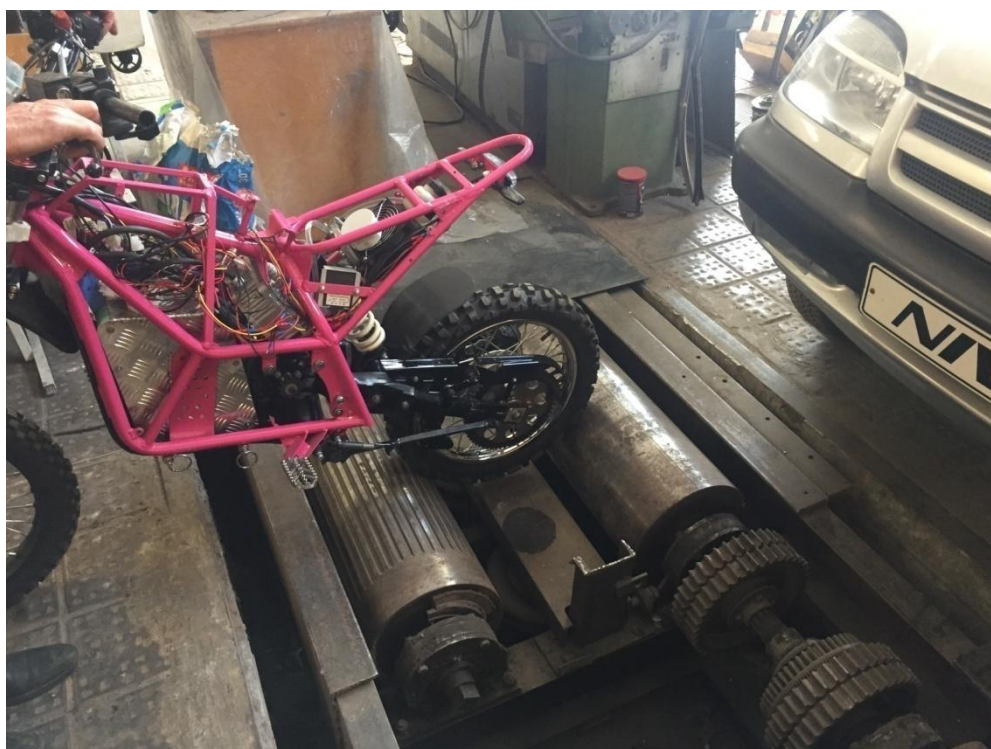
Рисунок 5.5 – Определение мощности на ведущем колесе электрического мотоцикла по динамике разгона
