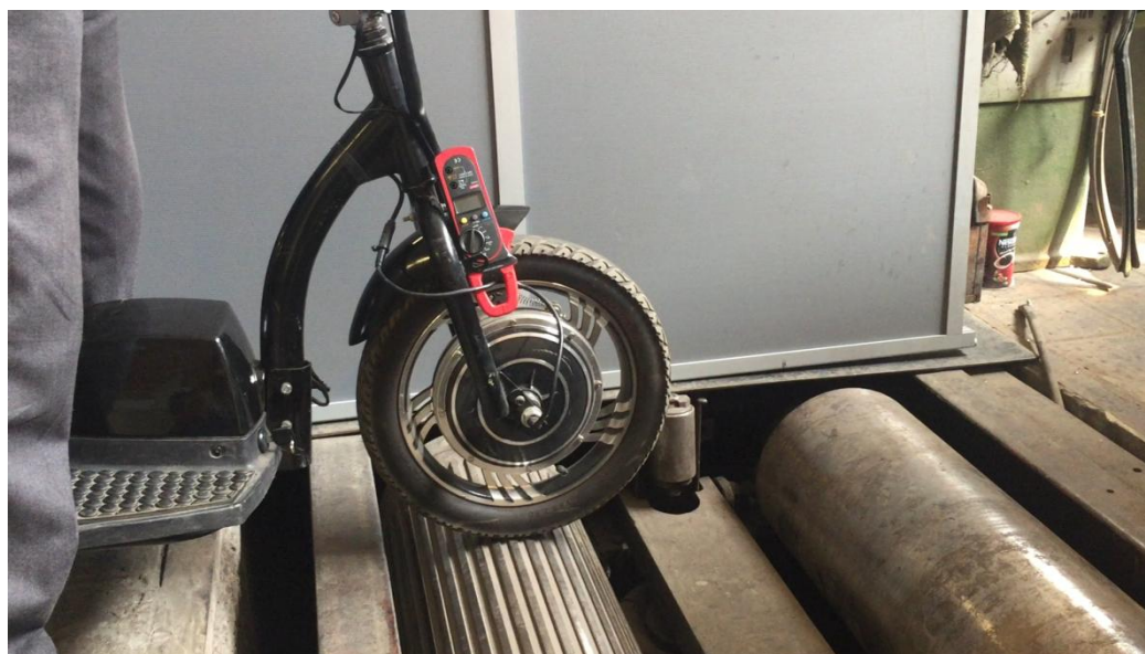
Рисунок 5.4 – Определение мощности мотор колеса электровелосипеда по динамике разгона
