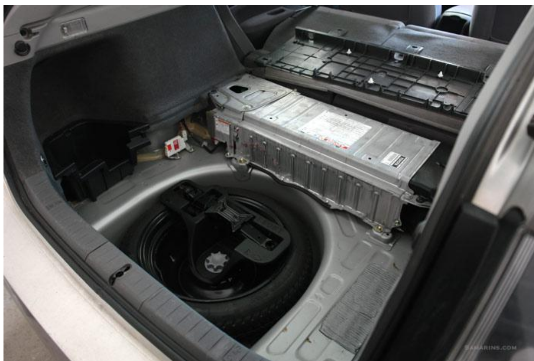
Рисунок 3.3 – Место расположения аккумуляторной батареи в багажнике автомобиля
