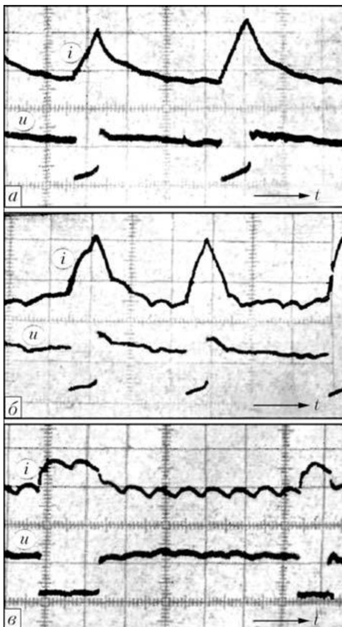
Рисунок 3.7 - Осциллограммы тока и напряжения при ограничении тока короткого замыкания дросселем (а), наклоном внешней характеристики сварочного выпрямителя, трансформатор которого имеет развитое рассеяние (б) и резистором (в)
