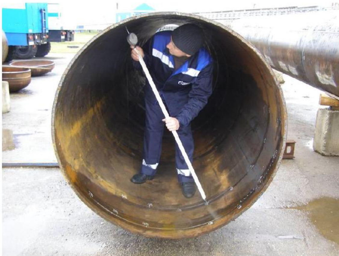
Рисунок 2.2 - Выполнение измерений нутромером НМ50-1300
