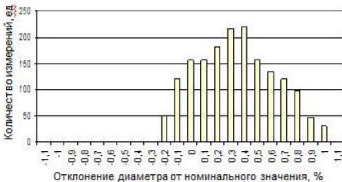
Рисунок 3.1 – Отклонения внутренних диаметров от номинального значения.
