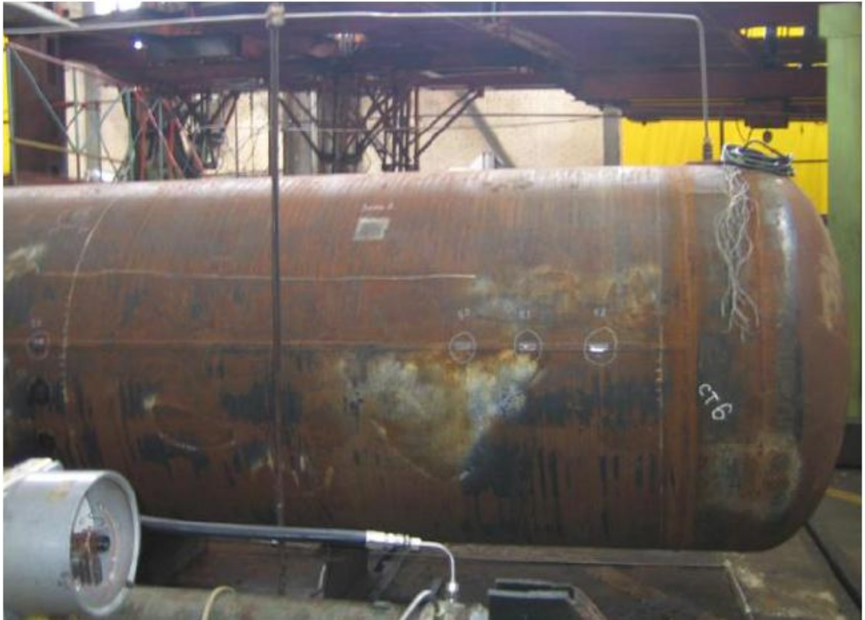
Рисунок 2.7 – Труба диаметром 1420 мм установленная на стенд
