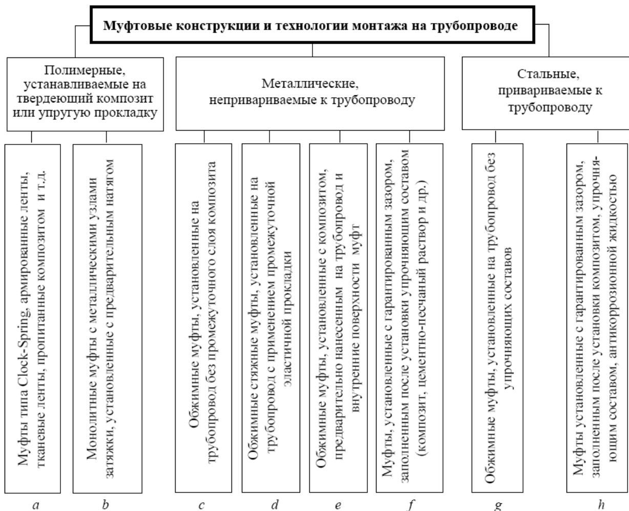
Рисунок 1.5 – Классификация конструктивно-технологических решений ремонта трубопроводов муфтовыми технологиями.
