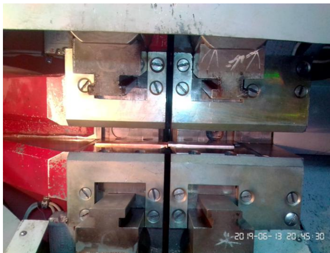
Рисунок 4.9- Стыковка торцев CuиAl шин
