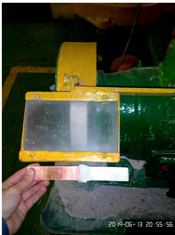
Рисунок 4.13 – Формирование Cu-Al переходника
