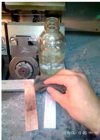
Рисунок 4.8 – Подготовка поверхностей под сварку (обезжиривание)
