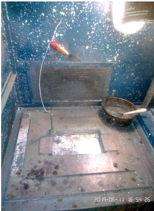
Рисунок 4.28 - Ванна с припоем Медную часть наконечника, изготовленную методом штамповки, окунаем во флюс (рис.4.29).
