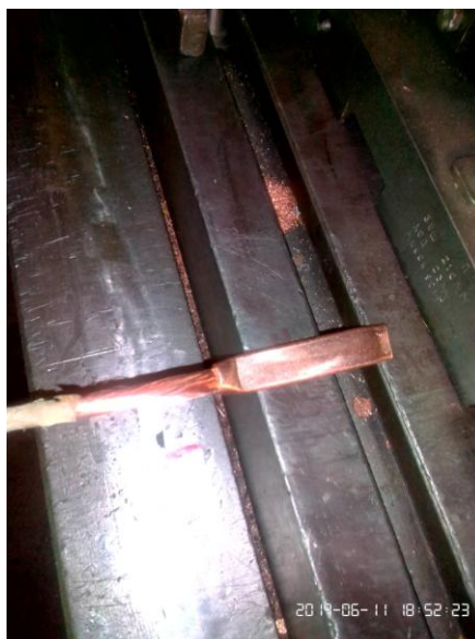
Рисунок 4.18 –Формовка наконечника штампом
