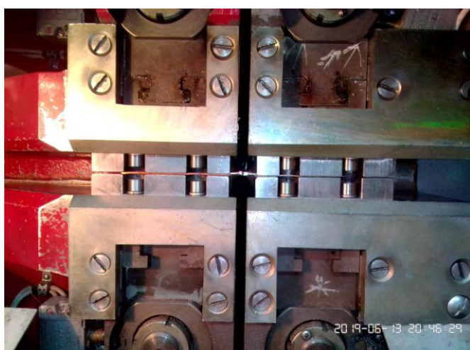
Рисунок 4.10 – Первый прогон сварки
