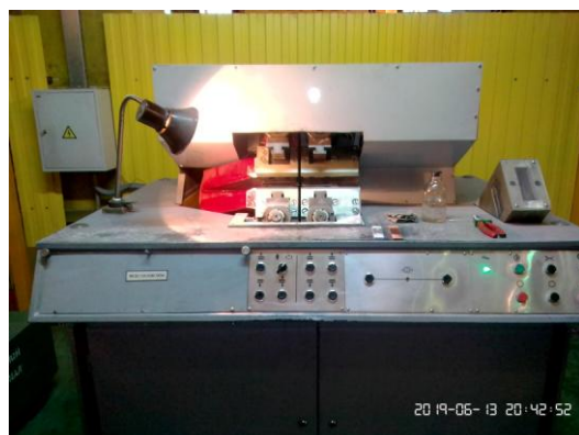
Рисунок 3.5 – Внешний вид машине для холодной стыковой сварки МСХС-8
