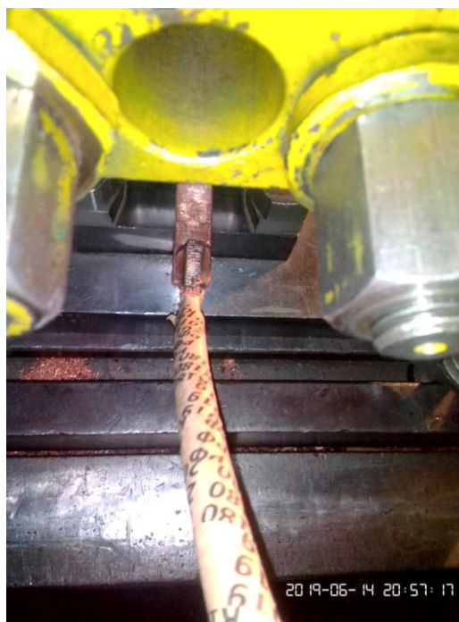
Рисунок 4.20 - Пробивка отверстий в наконечнике Al-Cu
