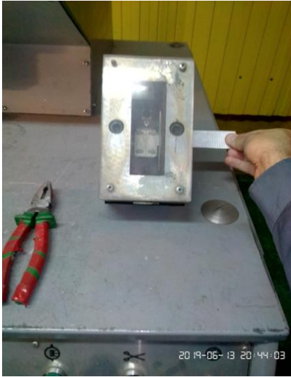
Рисунок 4.6- Подготовка к холодной сварке Ашины
