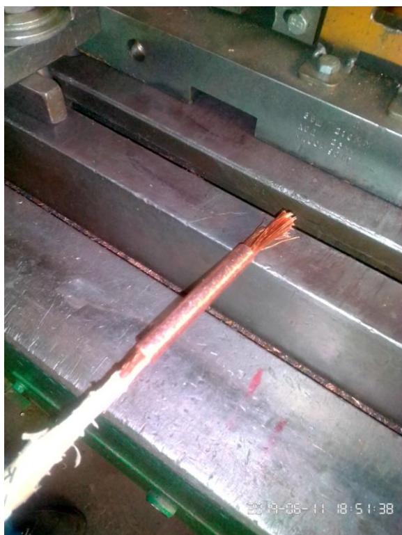
Рисунок 4.14—Сборка медной трубы с медными жилами кабеля
