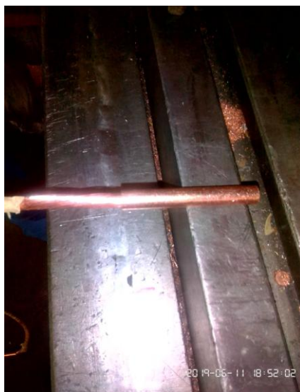
Рисунок 4.17 - Выравнивается провод с концом трубы
