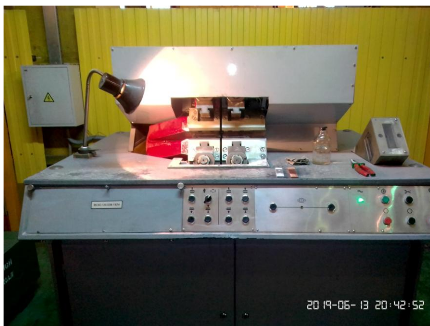
Рисунок 4.2 - Машина холодной стыковой сварки типа МСХС-8.
