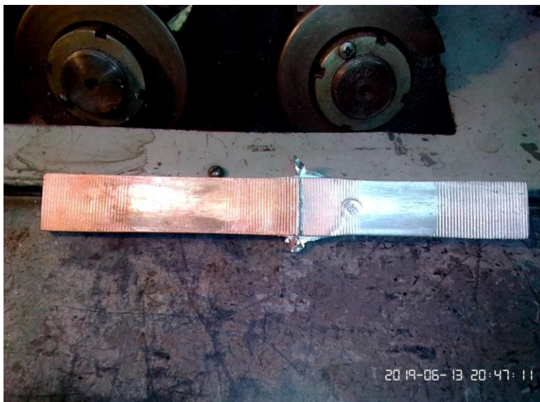
Рисунок 4.11 – Шина Cu-Al после холодной сварки
