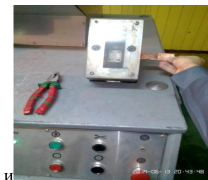
Рисунок 4.5- Подготовка к холодной сварке Сишины
