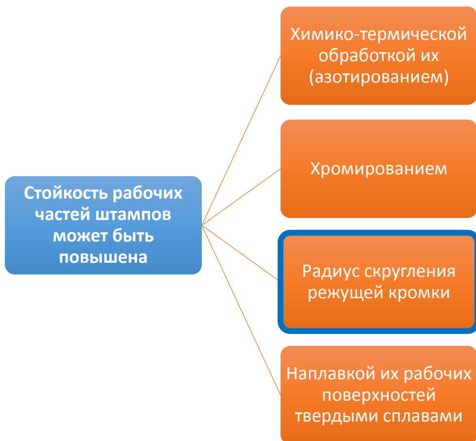
Рисунок 1.6 – Способы повышения стойкости рабочих частей разделительных штампов
