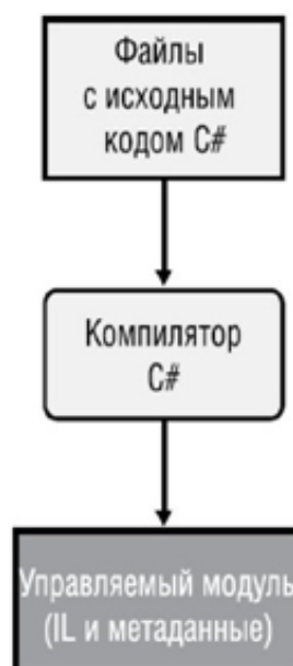
Рисунок 2.5 – Схема компиляция исходного кода в управляемые модули
