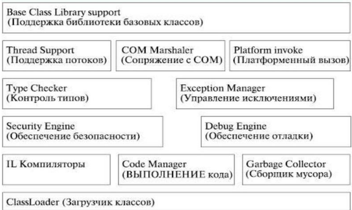
Рисунок 2.7 – Структура среды выполнения CLR (основные функциональные элементы среды)
