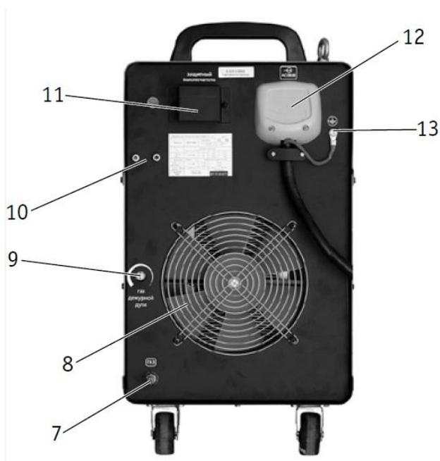
7 - Вход сжатого воздуха; 8 - Вентиляционные отверстия; 9 - Регулятор давления; 10 - Крепление фильтра-регулятора; 11 - Тумблер включения; 12 - Сетевой кабель; 13 - Крепление провода заземления.
