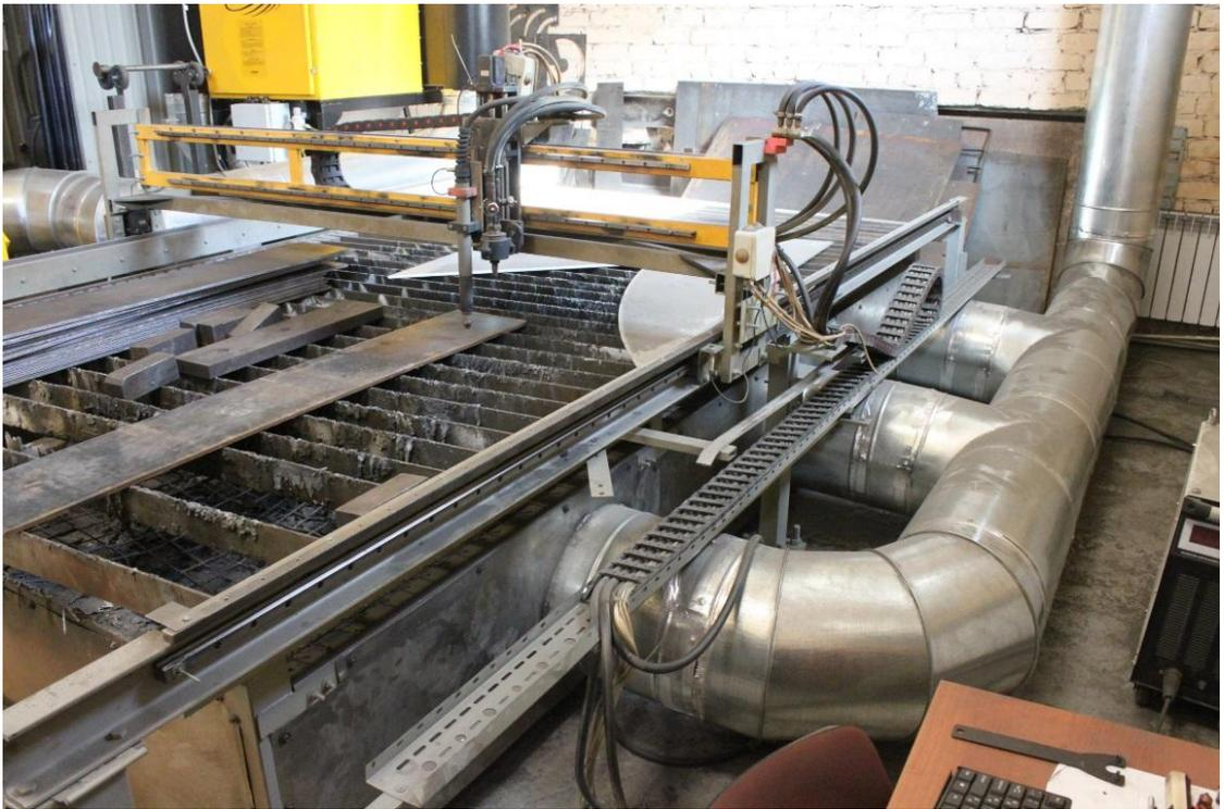
Рисунок 3.27 – Вытяжная системы плазменного стола
