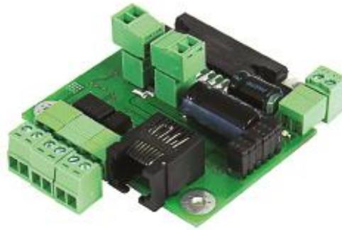
Рисунок 3.19 - Микрошаговый драйвер шагового двигателя PLD331
