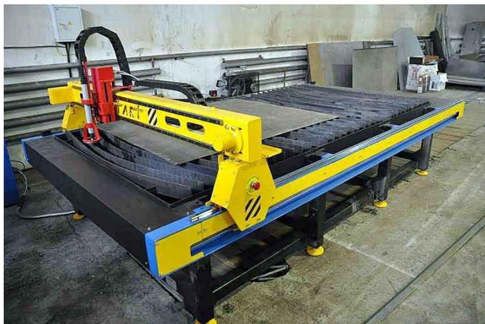
Рисунок 1.1 - Станок плазменной резки металла с ЧПУ «СК Старт 15-30»
