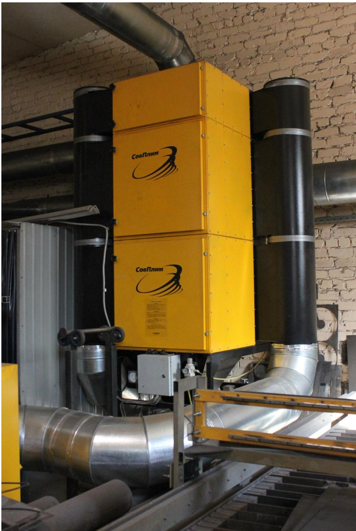
Рисунок 3.29 – Система фильтрации воздуха (грубая и тонкая очистка)
