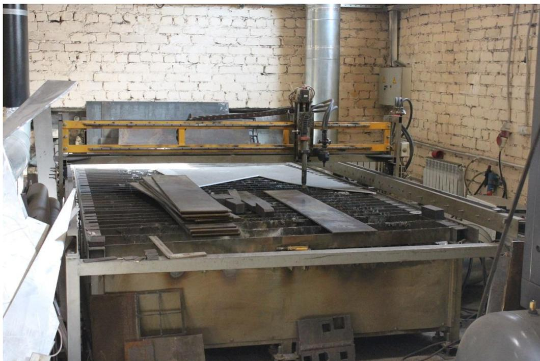
Рисунок 3.25 – Установка плазменной резки с ЧПУ
