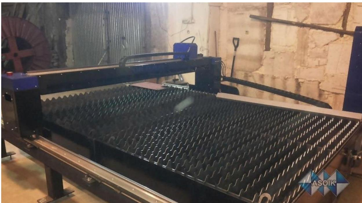
Рисунок 1.4 – Машина термической резки ASOIK Compact
