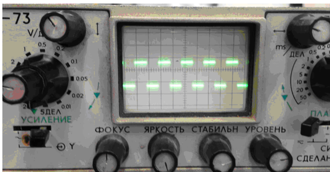
Рисунок 2.7 – График прямоугольной формы тока при работе установки ( f = 50\text{Гц} )
