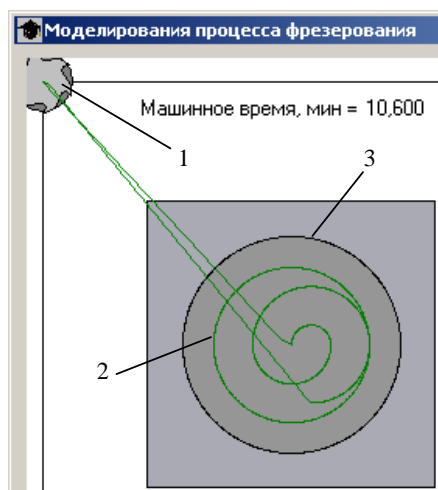
Рисунок 3.6 – Окончание моделирования фрезерования внутреннего цилиндра
