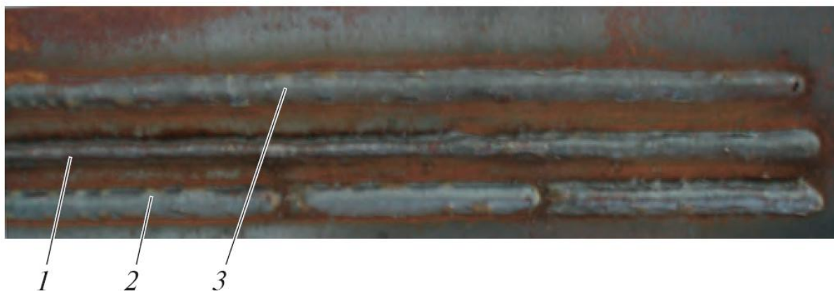
Рисунок 1.5 – Валики наплавленные при традиционной (1), импульсной (2) и импульсной с обратной связью подаче проволоки (3)
