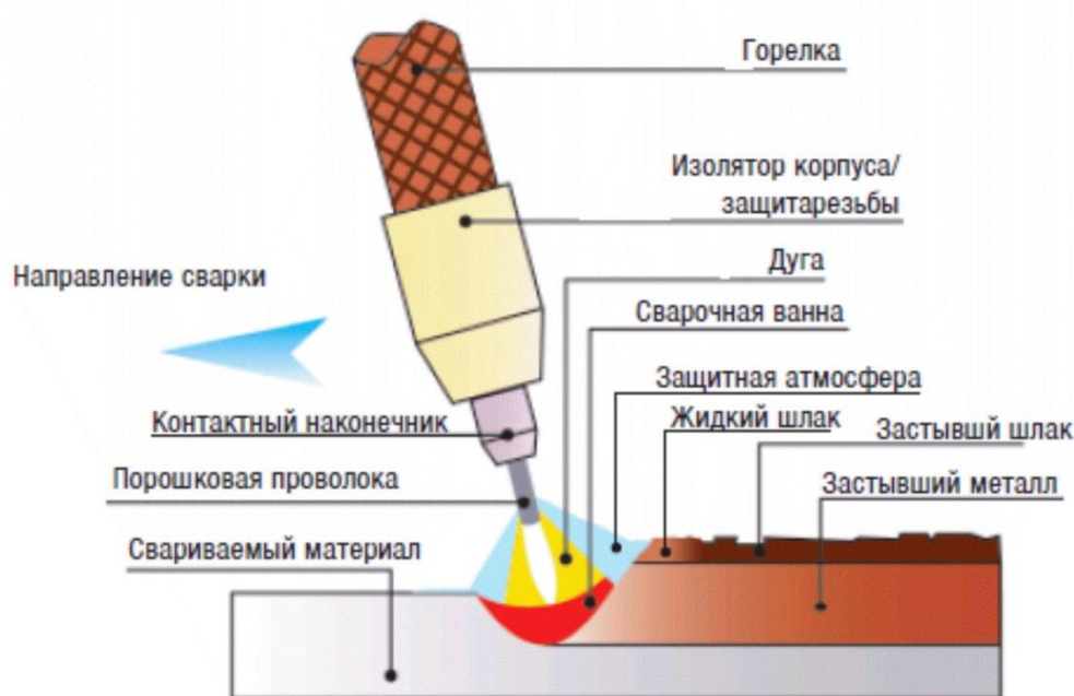
Рисунок 2.4 – Схема механизированной сварки самозащитными порошковыми проволоками
