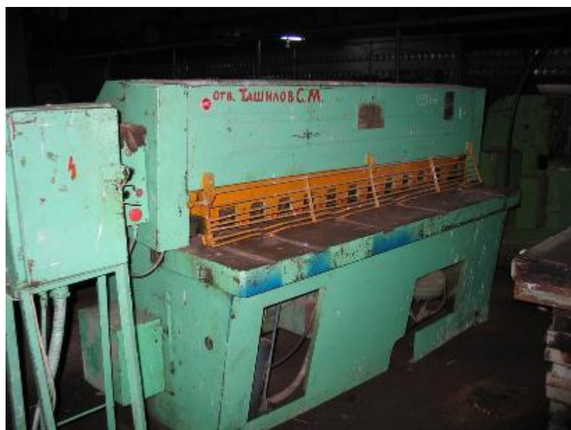
Рисунок 2.8 – Гильотинные ножницы НД-3318
