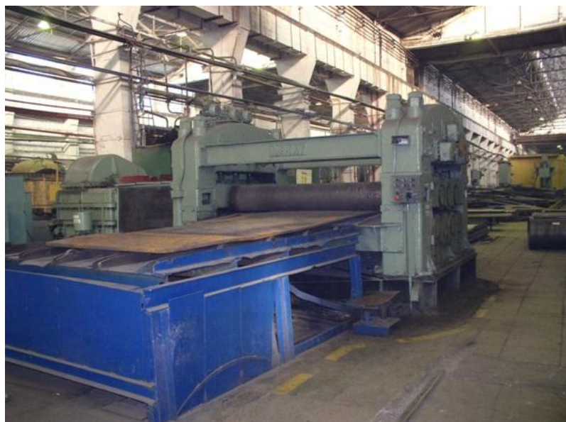
Рисунок 2.6 – Правка листового проката на многовалковой машине
