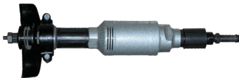
Рисунок 1.7 – Радиальная шлифовальная машина ИП-2014
