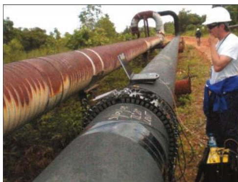
Рисунок 2.1 - Низкочастотная ультразвуковая диагностика
