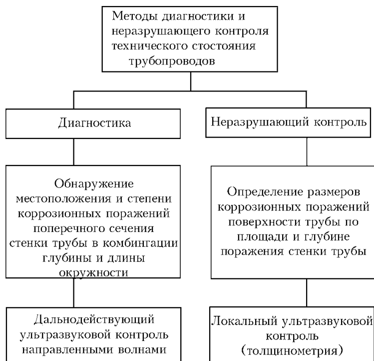
Рисунок 2.9 – Комплексные методы диагностики и контроля технического состояния трубопроводов
