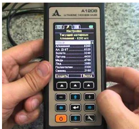
Рисунок 1.6 – Ультразвуковой толщиномер А1208
