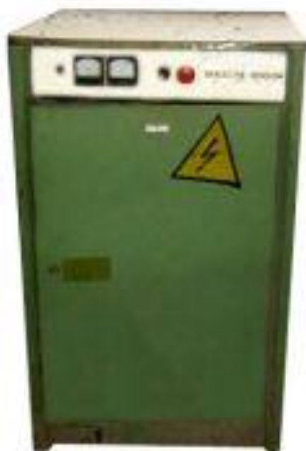
Рисунок 3.1- Сварочный выпрямитель ВКСМ-1000
