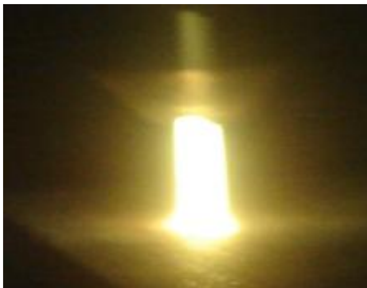
Рисунок 1.8- Плазменная (сжатая) дуга, горящая на графит
