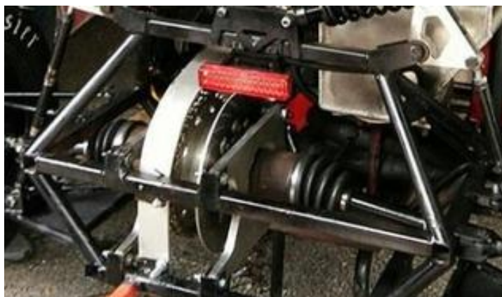
Рисунок 2.1 – Конструкция дифференциала команды Destrierracing
