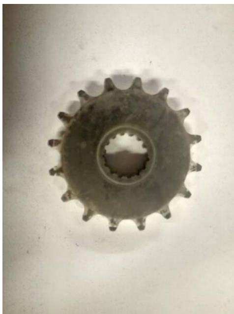
Рисунок 3.15– Звезда оригинальная ведущая от мотоцикла
