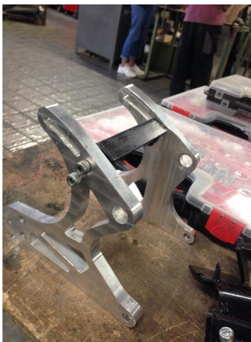
Рисунок 3.11– Кронштейн крепления дифференциала в сборе
