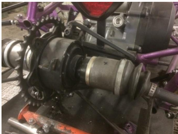
Рисунок 2.3– Конструкция крепления дифференциала болида «Скорпион 1»
