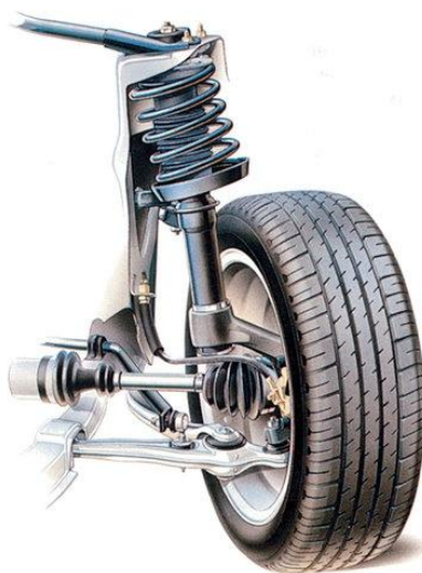
Рисунок 11 – Вариант исполнения подвески МакФерсон
