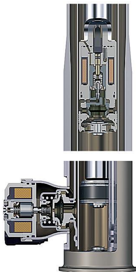
Рисунок 5 – Однотрубный гидравлический амортизатор ZF
