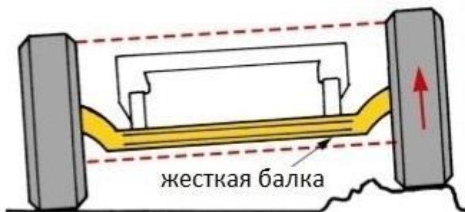
Рисунок 1 – Схема зависимой подвески
