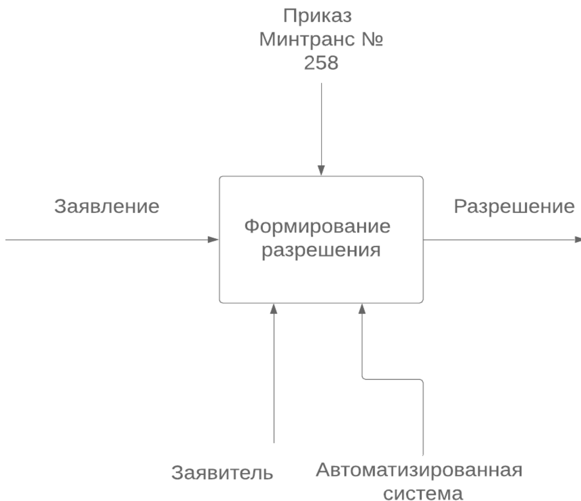
Рисунок 1.4 – диаграмма IDEF0 верхнего уровня «КАК ДОЛЖНО БЫТЬ» процесса «Автоматизация процесса формирования разрешения»
