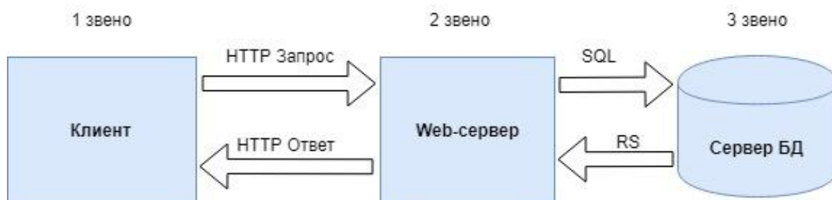
Рисунок 2.5 – Модель трехзвенной архитектуры «Клиент-Сервер»
