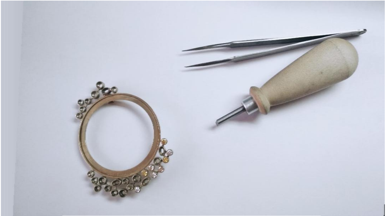
Рисунок 31.Закрепка фианитовых вставок. Зубакова Н. А. ДПИп-1501, 2019 г.
