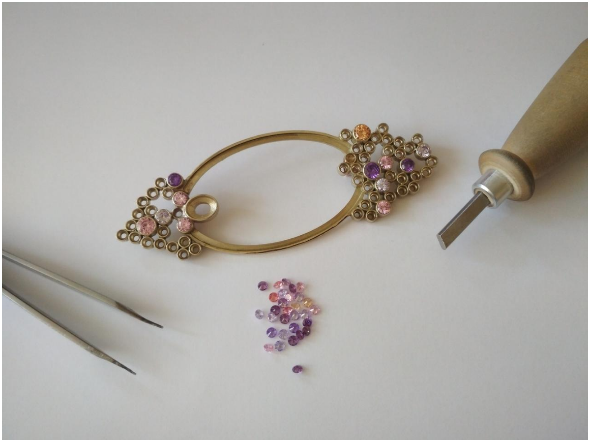
Рисунок 32.Закрепка фианитовых вставок. Зубакова Н. А. ДПИп-1501, 2019 г.
