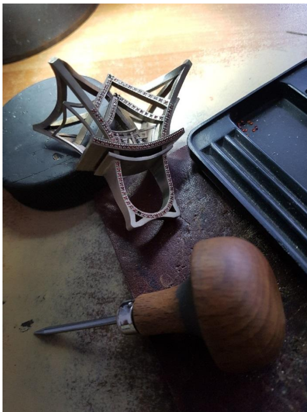
Рисунок 59 – процесс закрепки камней в кольцо из серии колец «Яран 2.0», ДПИп-1501, Е. Береснева, 2019 г.
