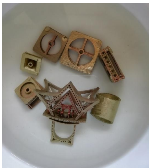
Рисунок 55 – процесс отбеливания изделий в лимонной кислоте, ДПИп-1501, Е. Береснева, 2019 г.
