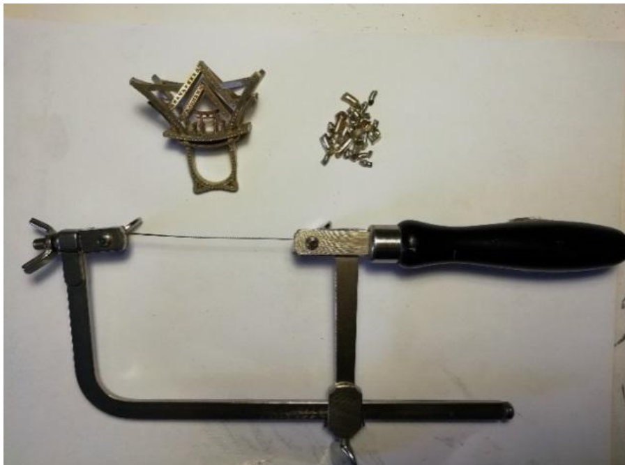
Рисунок 57 – отпиливание литников от второго кольца из серии колец «Jaran 2.0», ДПИп-1501, Е. Береснева, 2019 г.
