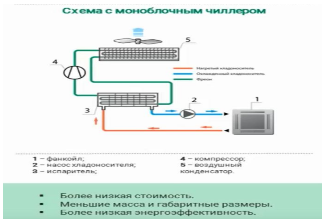
Рисунок 4.3.1 – Схема с моноблочным чиллером
