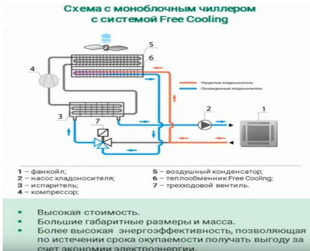
Рисунок 4.3.2 – Схема моноблочного чиллера с системой естественного охлаждения.
