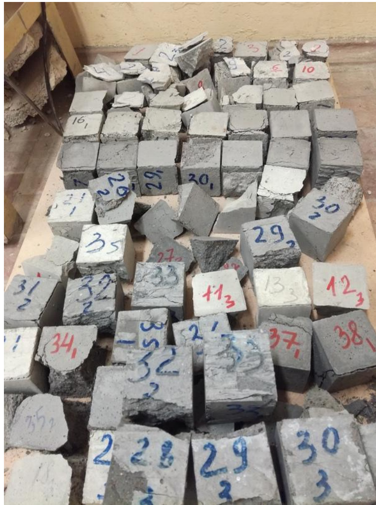
Рисунок 3.4 – Образцы бетона после испытания на прочность
