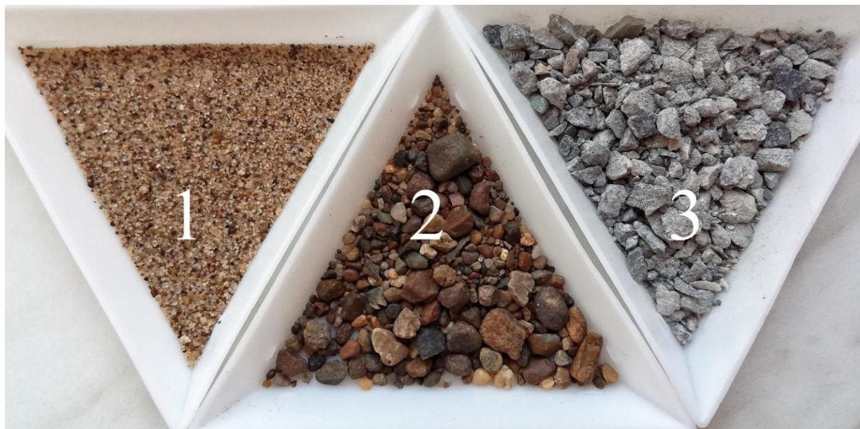
1) Волжский песок; 2) Камский песок; 3) песок дробленый из гранита Рисунок 3.1 - Виды заполнителей для бетонной смеси
