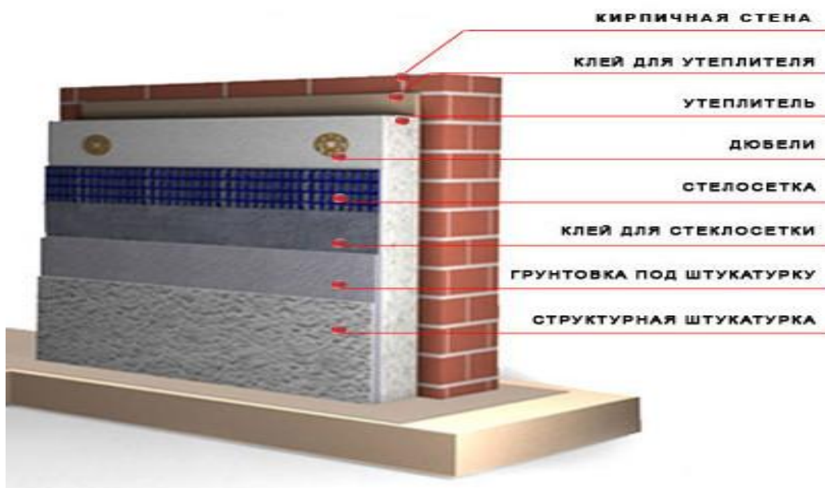
Рисунок 2.4 - Конструкция мокрого фасада
