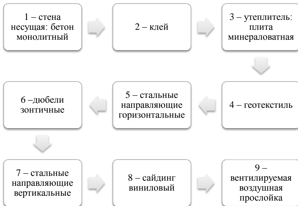
Рисунок 2.6 - Технологическая модель вентилируемого фасада по варианту №1 «самый дешевый» по критерию оптимизации D_1 – минимум стоимости
