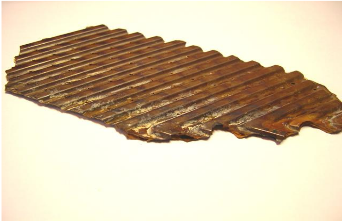
Рисунок 2.10 – Образец отложений, извлеченный из пластинчатого теплообменника (г. Сергач)
