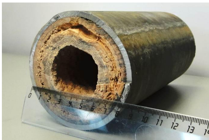
Рисунок 1.2 – Образование накипи на трубах
