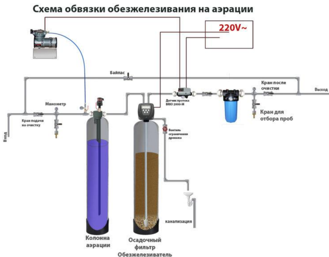
Рисунок 2.5 – Обезжелезивание на аэрации
