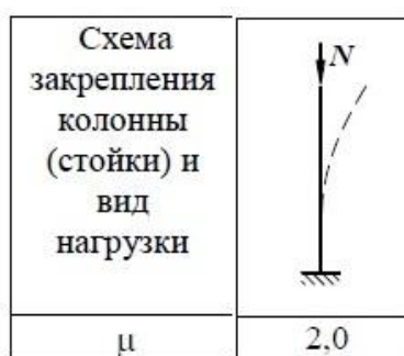
Рисунок 2.7 - К определению расчетной длины колонн
