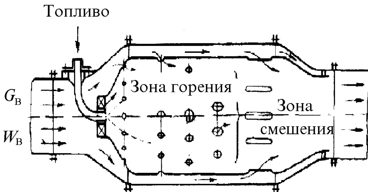
Рисунок 5 - Процесс горения природного газа в малоэмиссионной камере сгорания
