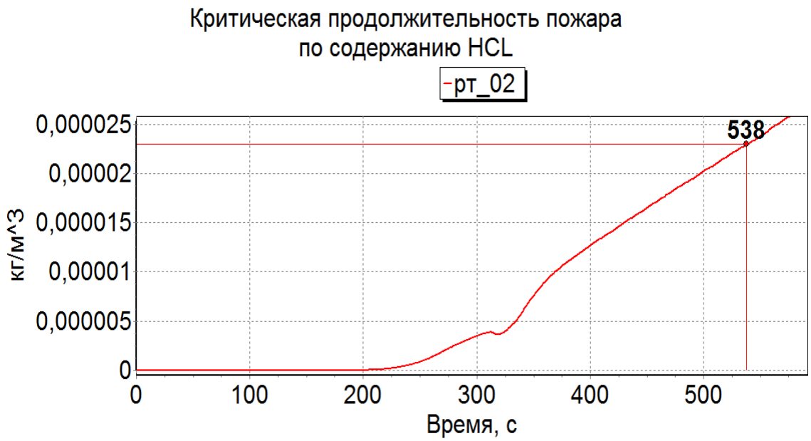
Рисунок 3.2 – График продолжительности пожара по содержанию HCL
