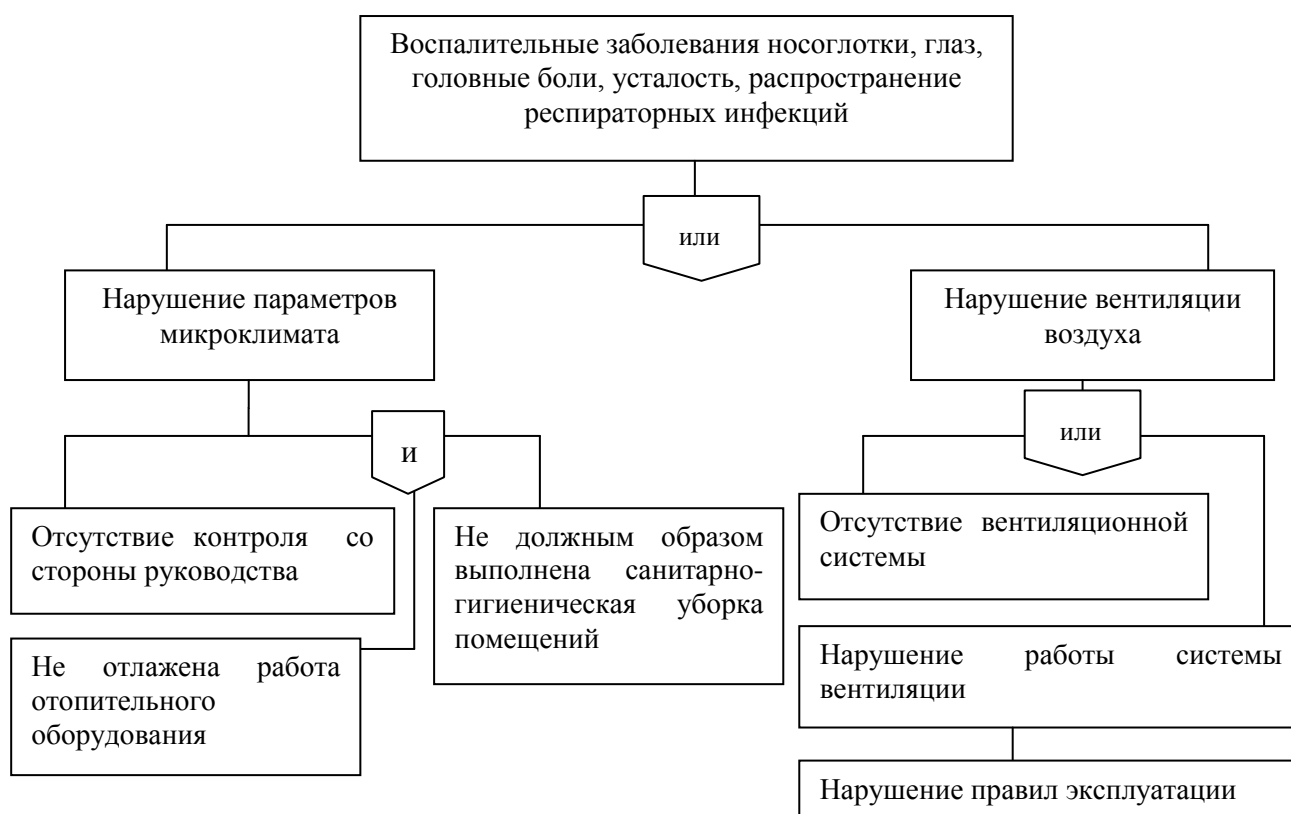
Рисунок 3.2 – «Дерево событий», для наиболее вероятного происшествия в образовательном учреждении, выявленного экспертным методом
