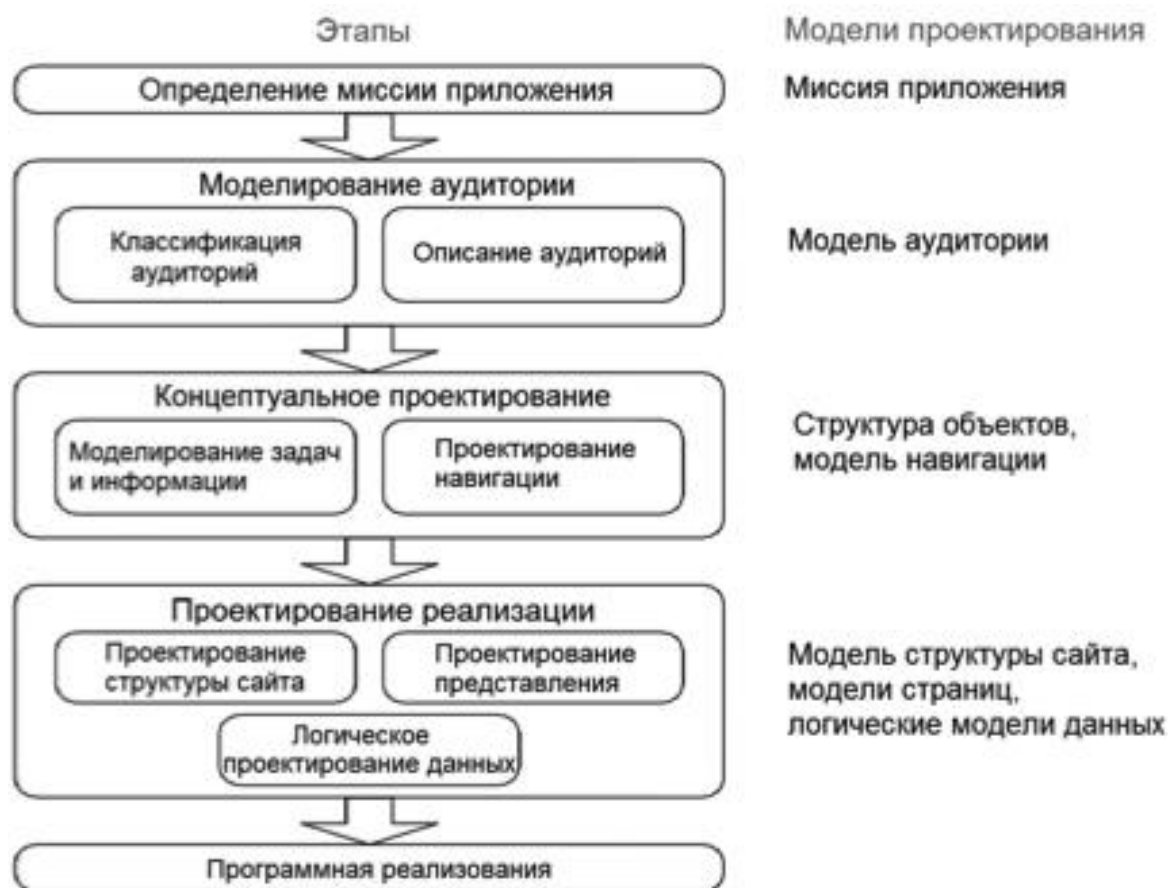
Рисунок 5 – Этапы модели разработки WSDM
