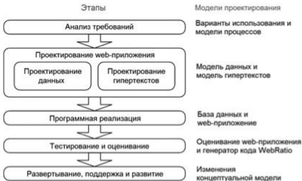
Рисунок 4 – Этапы модели разработки WebML
