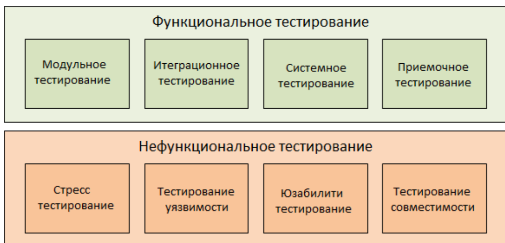
Рисунок 1.2 – Общая схема основных видов тестирования
