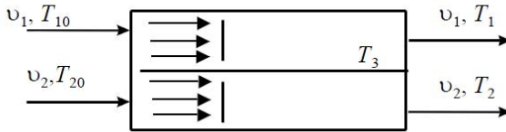
Рис. П6.6. Теплообменник типа «вытеснение – вытеснение»
