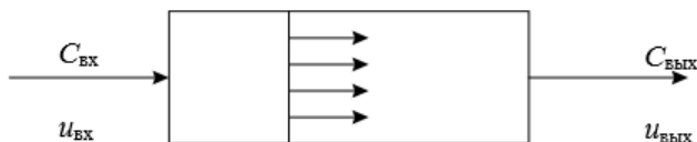
Рис. Л4.2. Модель идеального вытеснения: u_{\text{ВХ}}, u_{\text{ВЫХ}} – линейная скорость потока на входе и выходе из аппарата, м/с
