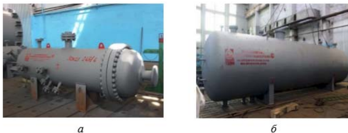
Рис. Л6.1. Виды сепараторов: a – газосепаратор сетчатый; б – нефтегазовый сепаратор
