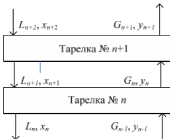
Рис. Лб.4. Схема потоков жидкости и пара на тарелках ректификационной колонны
