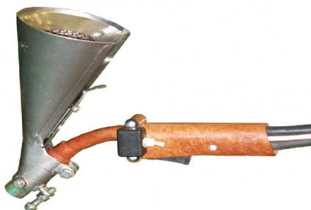
Рис. 2.13. Сварочная горелка А1231-5-Ф2 для механизированной сварки под слоем флюса
