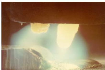
Рис. 4.9. Характерное расположение электродов в трехфазной горелке
