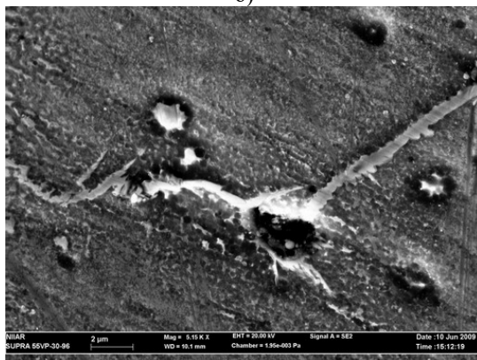
Рис. 2.13. Форма включений в наплавленном валике: a – компактные; б – пластинчатые; в – игольчатые
