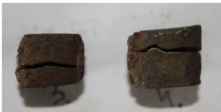
Рис. 3.7. Внешний вид образцов наплавленного металла после испытаний на термостойкость в водяных теплосменах
