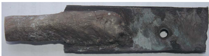
Рис. 3.15. Образец с интерметаллидным покрытием системы железо-алюминий после проведения эрозионных испытаний
