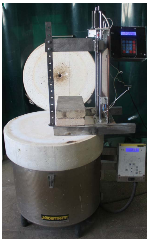
Рис. 3.11. Фото установки для определения эрозионной стойкости наплавленных покрытий
