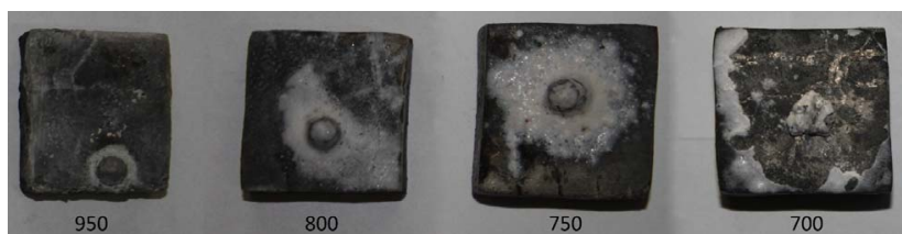
Рис. 3.9. Растекание алюминия АК12 по наплавленному интерметаллидному сплаву с активацией поверхности флюсом системы NaCl-NaF-Na 3 AlF 6 при температурах: 700 °С, 750 °С, 800 °С, 950 °С
