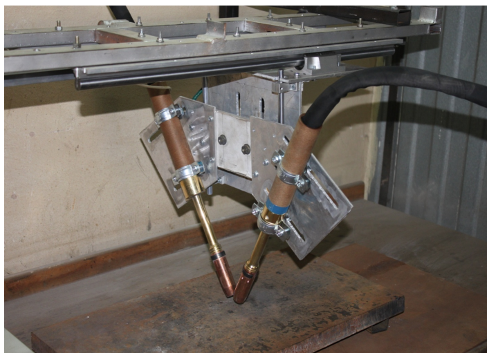
Рис. 2.7. Установка для автоматической двухдуговой наплавки
