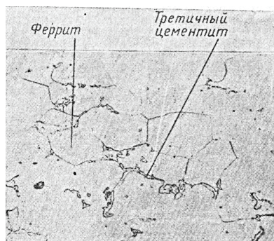
Рис. 5.3. Микроструктура сплава с 0,015 % С (феррит + третичный цементит) после травления 4-процентным спиртовым раствором азотной кислоты (x200)
