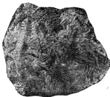
Рис. 1.4. Слиток сурьмы. Кристаллизация в виде дендритов
