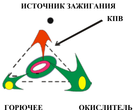
Рис. 3.1. Схема традиционного треугольника пожара с указанием области концентрационных пределов воспламенения
