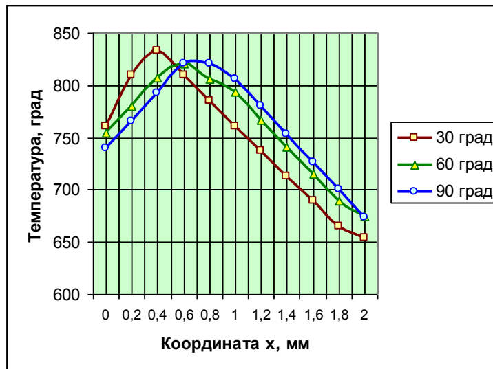
Рисунок 3.5 – Распределение температуры по передней поверхности
