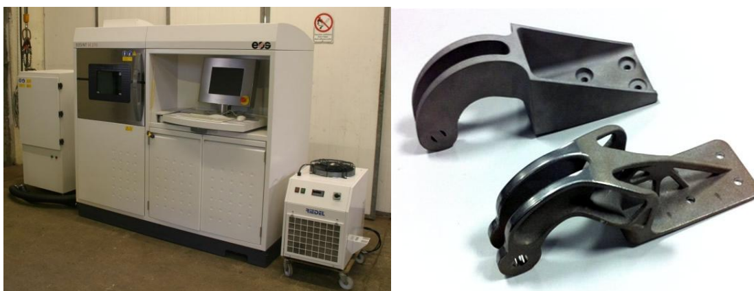
Рисунок 2.1 - 3D-принтер с технологией печати DMLS и изготовленная оптимизированная деталь в сравнении с оригинальной
