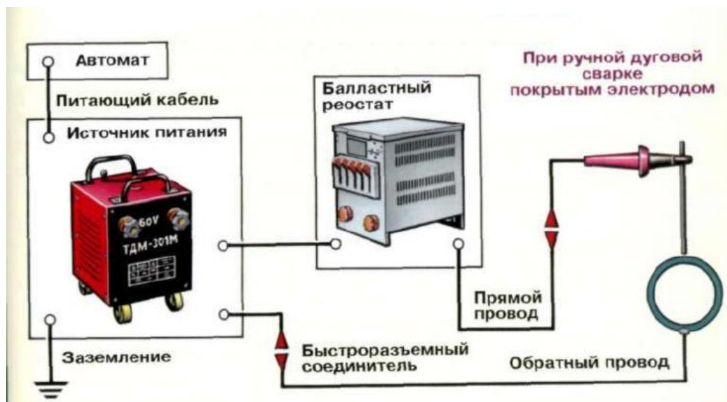
Рисунок 1.3 – Электродуговая сварка отдельными электродами
